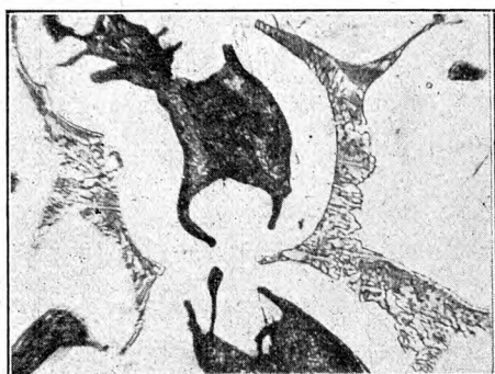
Rys. 36. Stal szybkochnąca przepalona. Wytrawiona odczynnikami chromowym. ( \times 1000 )
