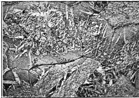
Rys. 23. Stal węglista o zawartości 1,5% C hartowana przy 1100° w lodowatej wodzie. Wytrawiona kwasem azotowym. Austenit + Martenzyt (× 500)
