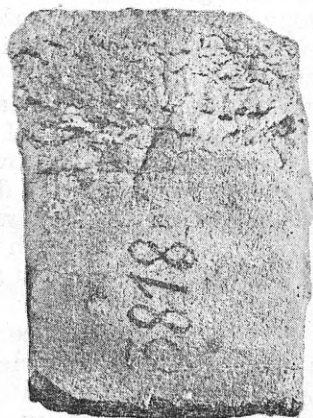
Rys. 11. Krajowa cegła magnezytowa po pracy w piecu martenowskim.
