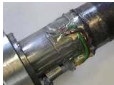
Rys. 16. Charakterystyka sprężysta śruby nr 1 a), widok śruby b), oraz powiększenie obszaru naklejenia tensometru c)
