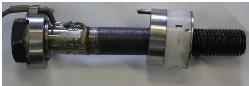
Rys. 16. Charakterystyka sprężysta śruby nr 1 a), widok śruby b), oraz powiększenie obszaru naklejenia tensometru c)
