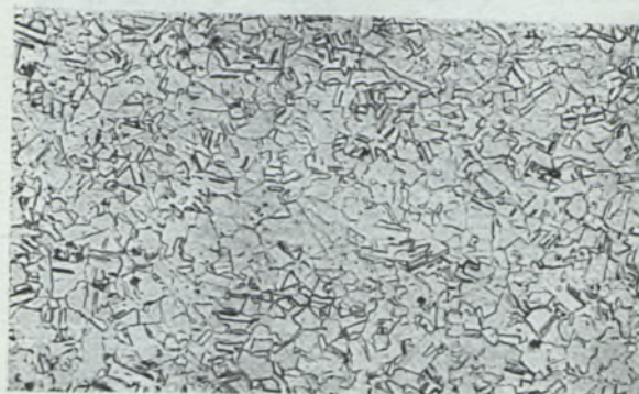
HNO_3 stęż. Ryc. 9. pow.=100 Struktura walcówki o grubości 6 mm. Miedź arsenowa.
