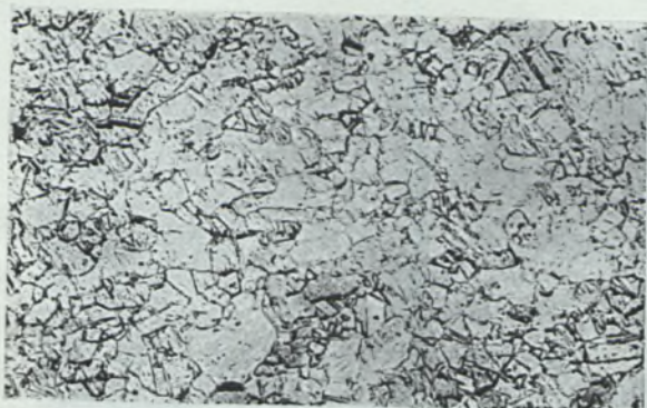
HNO_3 stęż. Ryc. 8. pow.=100 Struktura walcówki o grubości 6 mm. Miedź elektrolityczna.
