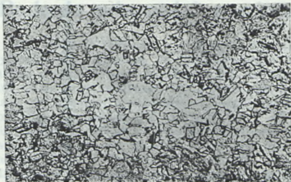
HNO_3 stęż. Ryc. 10. pow.=100 Struktura taśmy z miedzi elektrolitycznej.
