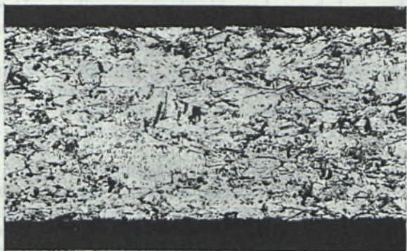
HNO_3 stęż. Ryc. 12. pow.=100 Struktura ścianki elementu wykonanego z miedzi elektrolitycznej.
