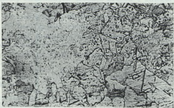
HNO_3 stęż. Ryc. 14. pow.=100 Struktura dna elementu wykonanego z miedzi elektrolitycznej.
