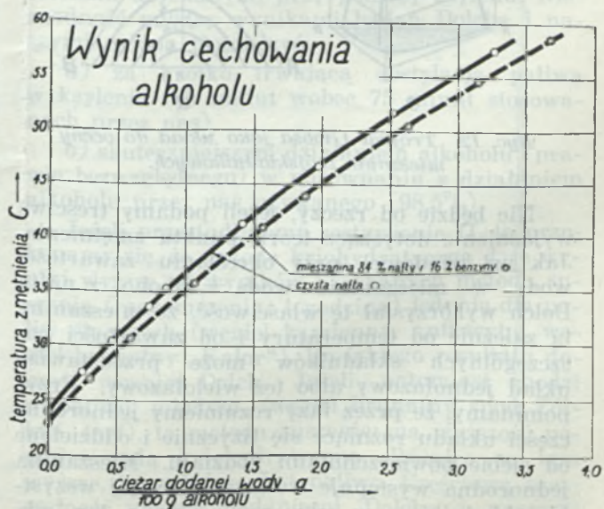
Ryc. 11. Krzywe cechownicze dla mieszaniny trójskładnikowej: woda + alkohol + nafta (+ benzyna).
