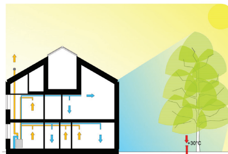
WENTYLACJA MECHANICZNA Z GWC LATEM MECHANICAL VENTILATION WITH GHE IN SUMMER
