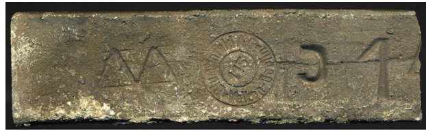
Il. 7. Stempel Richard Blumenfeld A.G. odkryty na awersie klinkierowej kształtki zdjętej z fasady domu handlowego Renoma we Wrocławiu (dawny Warenhaus Wertheim ) podczas rewitalizacji przeprowadzonej w latach 2007–2009 r. (fot. K. Kirschke)
