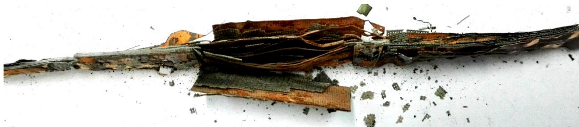
F_22. Otwarta struktura obwodu drukowanego po procesie zgazowania.
