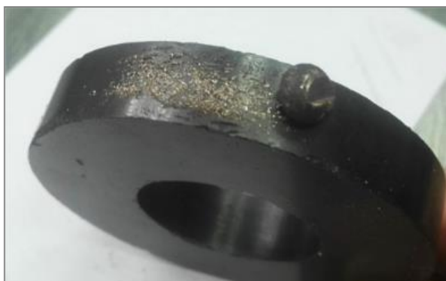
F_15. Rozdział metalicznych produktów przetapiania z użyciem magnezu.
