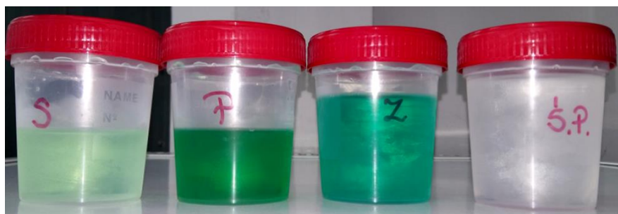
F_7. Roztwory po mineralizacji pozostałości po ługowaniu. S, P, Z, Ś.P. oznaczają odpowiednio pozostałość po: spopielaniu, pirolizie, zgazowaniu oraz próbę zerową.
