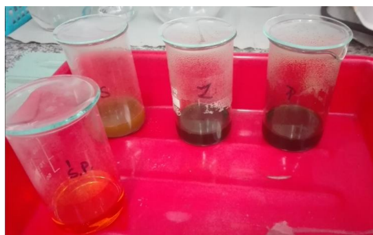
F_6. Próby z rozdrobionymi pozostałościami stałymi podczas mineralizacji aqua regia .
