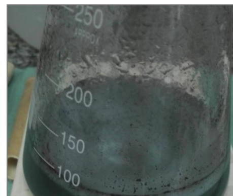
F_9. Intensywny przebieg pierwszego etapu ługowania pozostałości po zgazowaniu - widoczne pieniecie roztworu.
