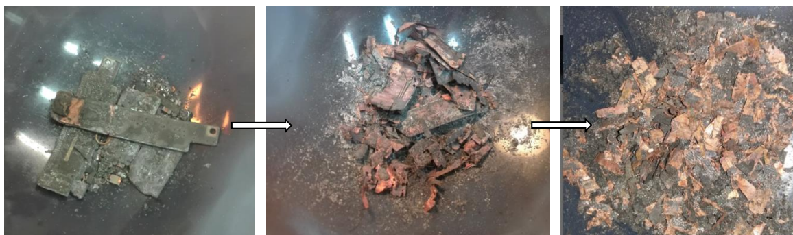
F_5. Przykładowy przebieg procesu rozdrabniania pozostałości stałej po zgazowaniu do procesu mineralizacji.
