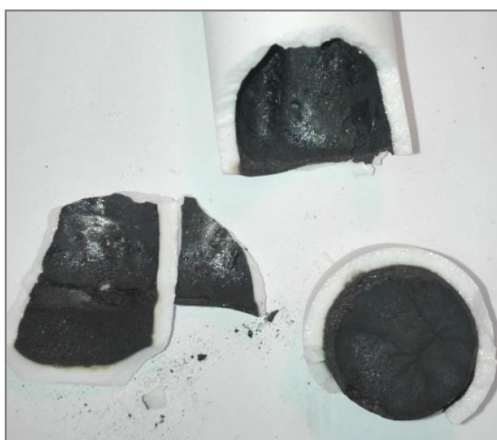
F_16. Produkty przetapiania w warunkach utleniających pozostałości po spopieleniu (wygląd wnętrza tygla).
