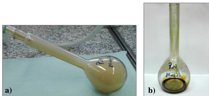
F_4. Kolba z frakcją ciekłą powstającą w procesie pirolizy. a) zadymienie w kolbie podczas procesu, b) kondensat po procesie.
