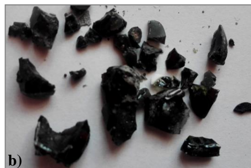
F_14. Produkty redukcyjnego przetapiania pozostałości po zgazowaniu; a) metaliczny wlewek; b) oddzielona faza żużlowa.
