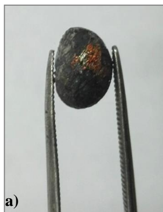
F_14. Produkty redukcyjnego przetapiania pozostałości po zgazowaniu; a) metaliczny wlewek; b) oddzielona faza żużlowa.
