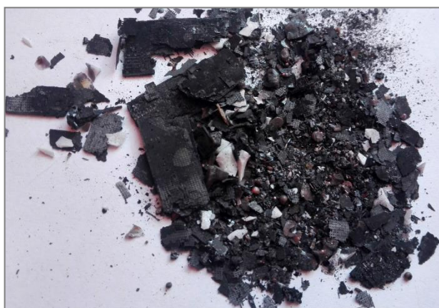
F_13. Materiał po pirolizie, który nie został całkowicie przetopiony podczas przetapiania redukcyjnego.
