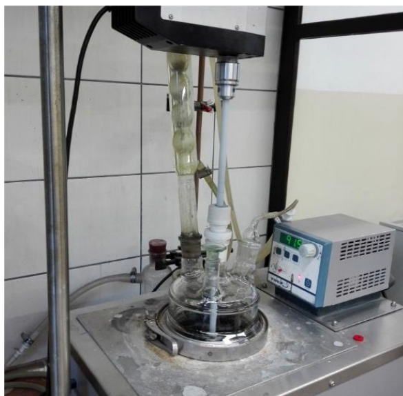
F_3. Układ zastosowany w procesach ługowania w podwyższonej temperaturze.
