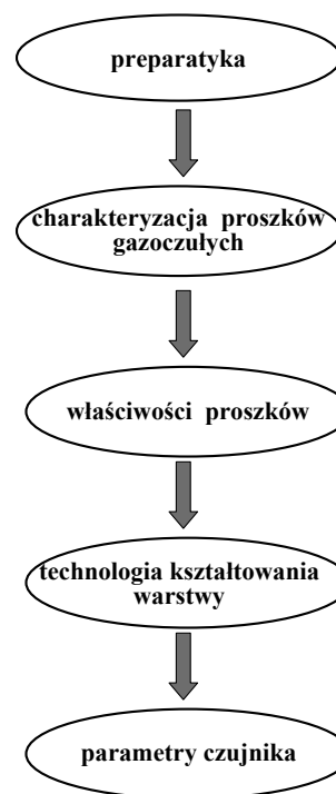
Rys. 5.8. Poszczególne etapy wytwarzania i charakteryzowania czujnika
