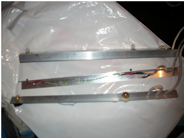
Rys. 7.8: Zestaw końcowy źródeł światła podczerwonego, parami rozmieszczonymi w jednakowych odległościach.
