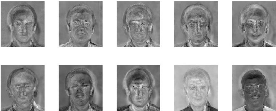
Rys. 5.10: Wyznaczona baza przestrzeni obrazów.
