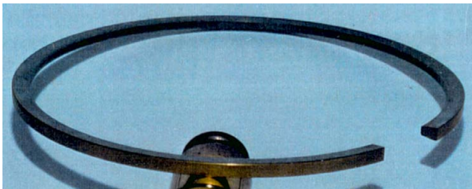
Rys. 8.2. Fotografia pierwszego pierścienia uszczelniającego z powłoką z TiN pierwszego gniazda silnika kierowanego do badań wstępnych
