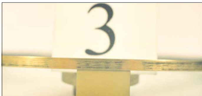
Rys. D.12. Widok powierzchni roboczej pierścienia 3/1 (gniazdo 3; wariant 3) po próbie trwałości zespołowej
