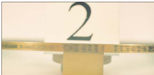
Rys. D.11. Widok powierzchni roboczej pierścienia 2/1 (gniazdo 2; wariant 4) po próbie trwałości zespołowej
