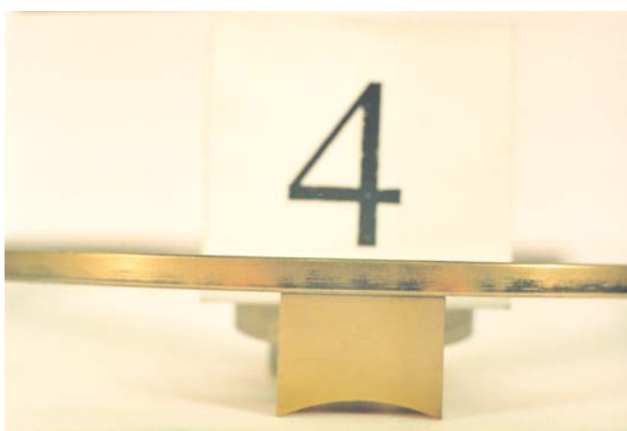
Rys. 10.10. Widok powierzchni roboczej pierścienia 4/1 (gniazdo 4; wariant 1) po próbie trwałości zespołowej
