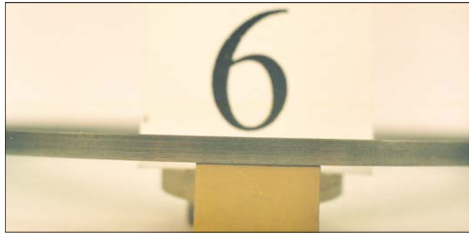
Rys. D.14. Widok powierzchni roboczej pierścienia 6/1 (gniazdo 6; standard) po próbie trwałości zespołowej
