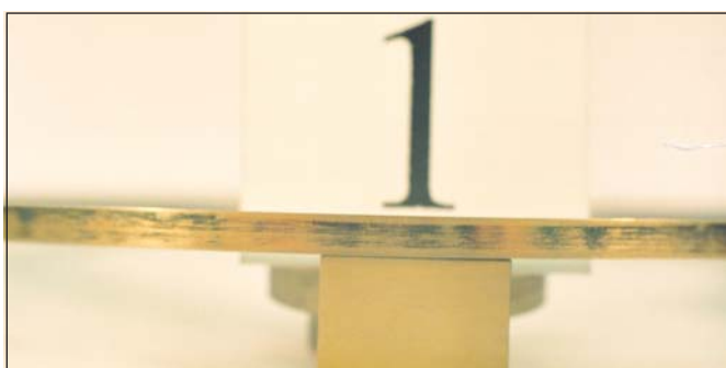
Rys. D.10. Widok powierzchni roboczej pierścienia 1/1 (gniazdo 1; wariant 2) po próbie trwałości zespołowej
