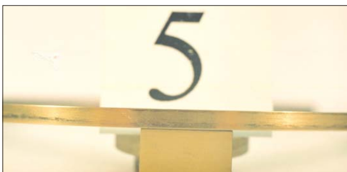
Rys. D.13. Powierzchnia robocza pierścienia 5/1 (gniazdo 5; wariant 4) po próbie trwałości zespołowej
