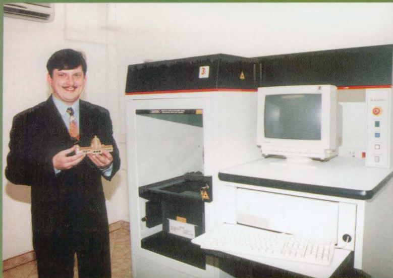
Dr inż. Tomasz Boratyński obok stereolitografu SLA 250/50 służącego do tworzenia fizycznych wzorcowych modeli z fotopolimerów ulegających warstwowemu usieciowaniu w wyniku oddziaływania sterowanej wiązki laserowej.
