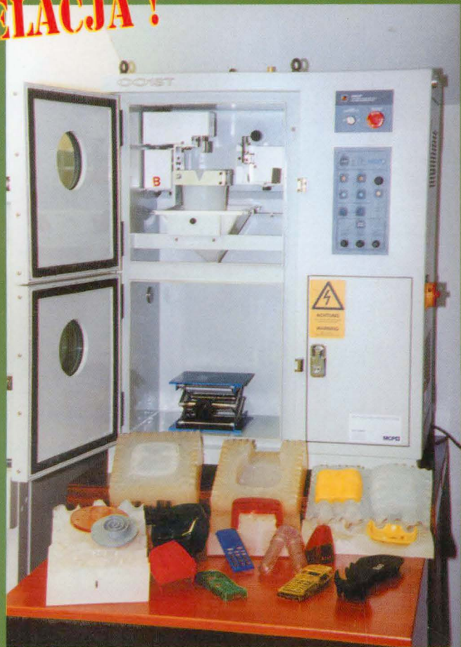
Urządzenie COO1 ST Vacuum Casting do próżniowego formowania pozwala na wytworzenie pojedynczych replik.
