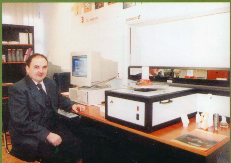
Dr inż. Bogdan Dybala przy przestrzennym digitizerze laserowym DigiBot II służącym do trójwymiarowej digitalizacji powierzchni i brył.
