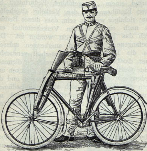
Zusammenklappbares „Styria“-Militärrad, Modell 1897.
