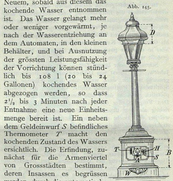
A Wasserausfluss, B Wasserbehälter, D Dampfkessel, H Handgriff zum Wasserablassen, S Geldeinwurf, T Thermometer, W Ausguss.
