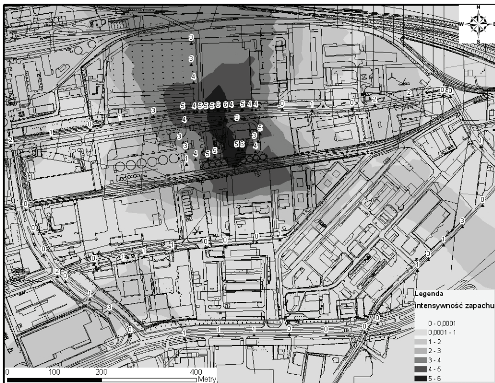
Rys. 4.13. Wyniki interpolacji intensywności zapachu uzyskane z zastosowaniem metody IDW wokół wybranego zakładu przetwórstwa rzepaku [104]
