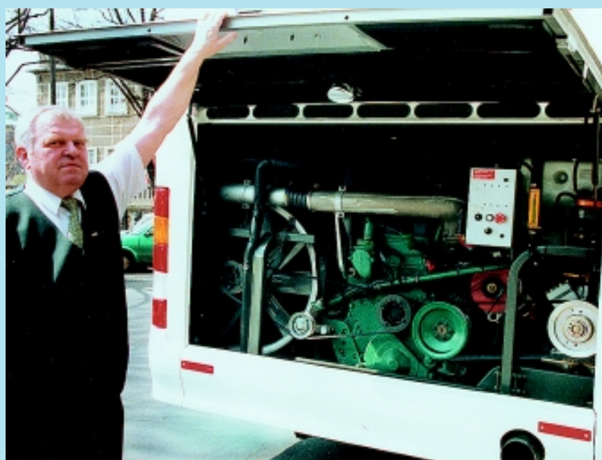
6-cylindrowy, 4-suwowy, wysokoprężny silnik z turbo doładowaniem o mocy 420 KM
