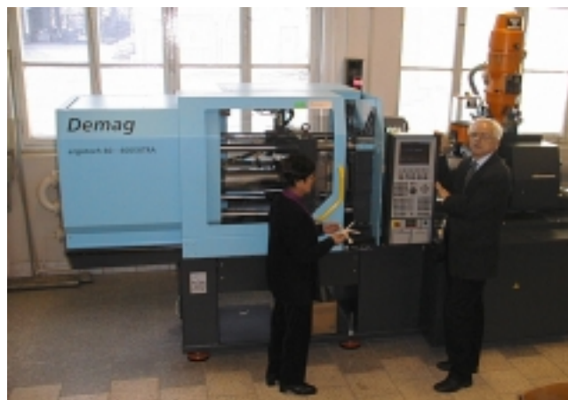
Inż. Andrzej Bielański i inż. Bogdana Chamska w trakcie wykonywania kształtek do badań własności wytrzymałościowych na wtryskarce DEMAGGergotech 80-400 Extra.
