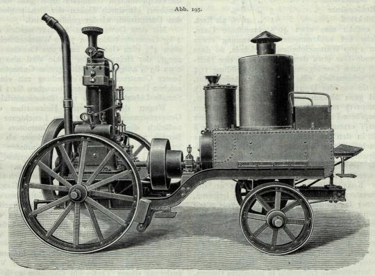
Petroleum-Locomobile von 8 PS der Deutzer Gasmotorenfabrik.
