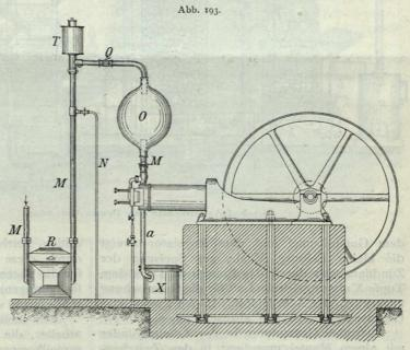
Schematische Darstellung einer Gasmotoranlage.
