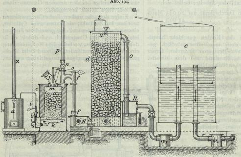
Schematische Darstellung einer Dowson-Gas-Anlage.
